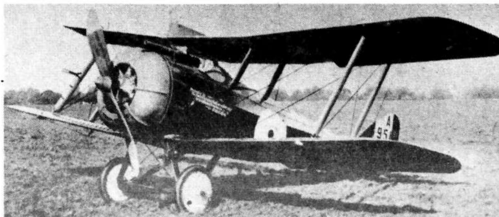
Sériový DH-5 s číslem A9513. Letoun již má zesílenou kapotu motoru a pod kabinou nese bílý nápis s věnováním, překvapivě častým u tohoto typu
