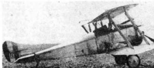
Prototyp DH-5 s plochým trupem a bez kamuflážního nátěru, s šikmo vzhůru nastaveným kulometem a s upravenými ocasními plochami. Dole je tentýž stroj v původní podobě bez výzbroje
