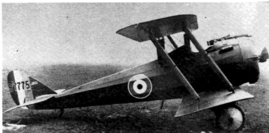
DH-5 se standardní kamufláží. Stroj se sériovým číslem B7775 je zachycen po generální opravě v roce 1917. Válcové těleso vpravo na trupu před kabinou je hasicí přístroj
